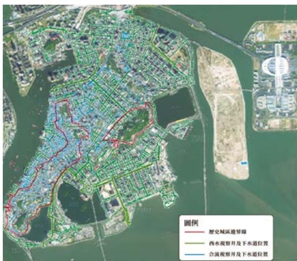
圖 5. 澳門半島及歷史城區排水管網 (圖片來源：筆者根據土地工務局資料繪製)
