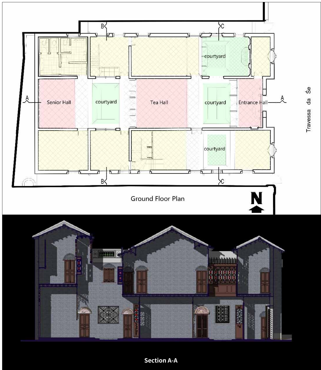
圖 2. 盧家大屋首層平面圖（上）、剖面示意圖（下）（圖片來源：朱宏宇、汪堅繪製，摘自《盧家大屋修復報告（0913000235）》成果文件，澳門特別行政區政府文化局委托，2009年4月至7月。）
