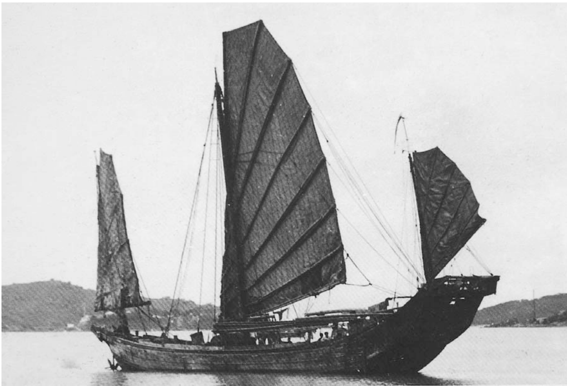
此為陽江、電白一帶漁民所有的福佬七榜拖網漁船，其三桅頂平，與港澳漁船之桅頂和舵背有異。
